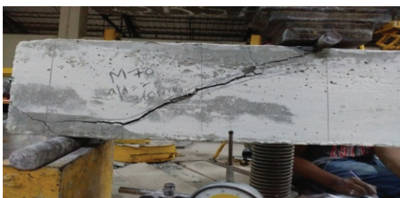
Rys. 13. Zniszczenie belki SCC70
