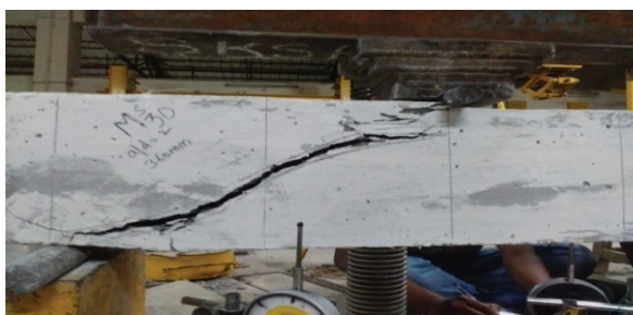
Rys. 11. Zniszczenie belki SCC30
