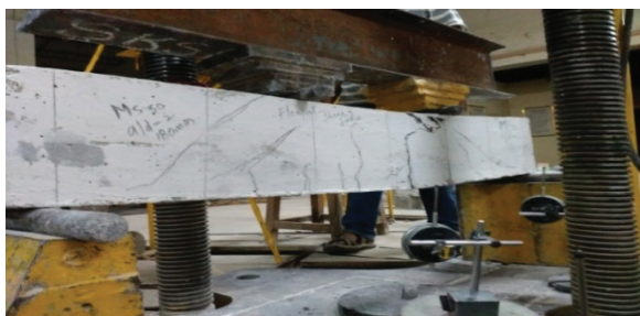
Rys. 12. Zniszczenie belki SFSCC30
